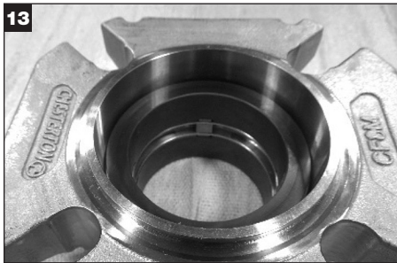
13 Die Schlitz im restlichen Gleitring-O-Ring auf die Klammern der Verdrehsicherung und des Durchfluss-Ableitblechs ausrichten und behutsam andrücken. Sicherstellen, dass der Dichtungsring vollständig sitzt.
