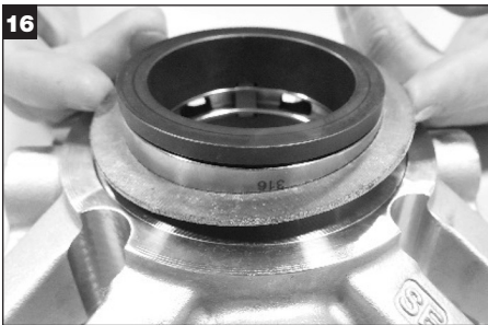
16 Die Dichtung aus dem Adapter entfernen und entsorgen.
