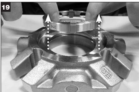
19 Den Mitnehmerkanal aus dem Dichtungsflansch entfernen; die Kanalklammern und das Durchfluss-Ableitblech aus dem Kanal entfernen und entsorgen.
