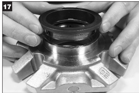
17 Den inneren Dichtungsring (Gegenring) aus dem Dichtungsflansch ausbauen und entsorgen.
