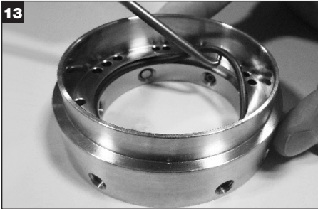
13 Den Klemmring-O-Ring (Y) entfernen und entsorgen.
