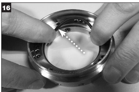
16 Eine dünne Fettschicht auf den O-Ring (Y) des Klemmrings auftragen und diesen in die Nut für den Klemmring am Innendurchmesser einsetzen.
