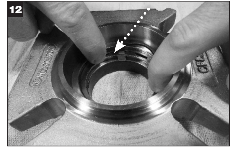
12 Den Dichtungsflansch behutsam umdrehen und auf ein sauberes Tuch legen, um die inneren Dichtungsflächen zu schützen. Eine dünne Fettschicht auf den restlichen Gleitring-O-Ring (X) auftragen und diesen in der Nut am Innendurchmesser des Dichtungsflansches montieren.
